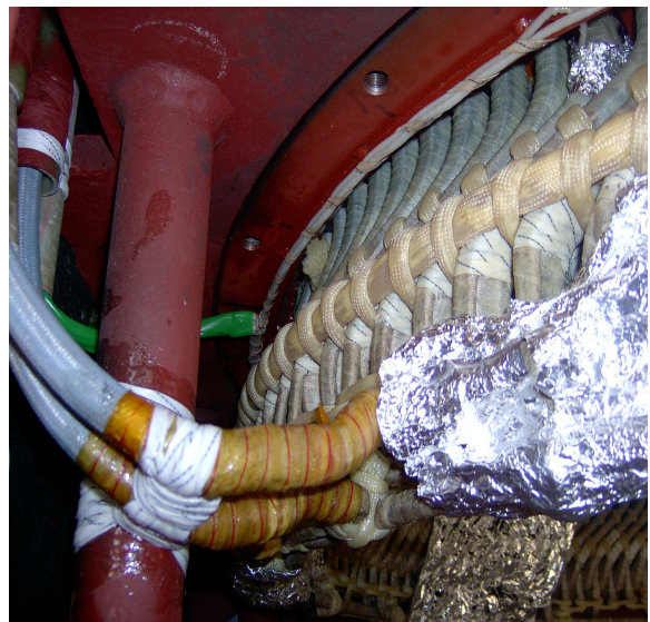
Rys. 9. Wnętrze stojana z fragmentem anteny pętlowej
