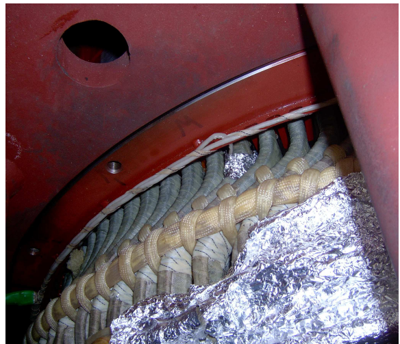
Rys. 8. Wnętrze stojana z fragmentem anteny pętlowej
