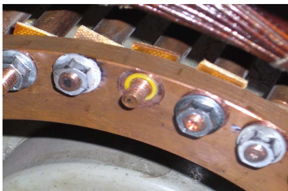
Rys. 2. Zamodelowane uszkodzenie jednego pręta
