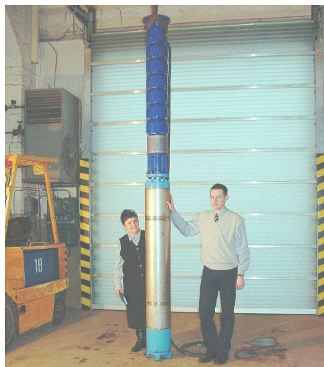
Fot. 6. Podwodny agregat pompowy z silnikiem o mocy 220 kW
