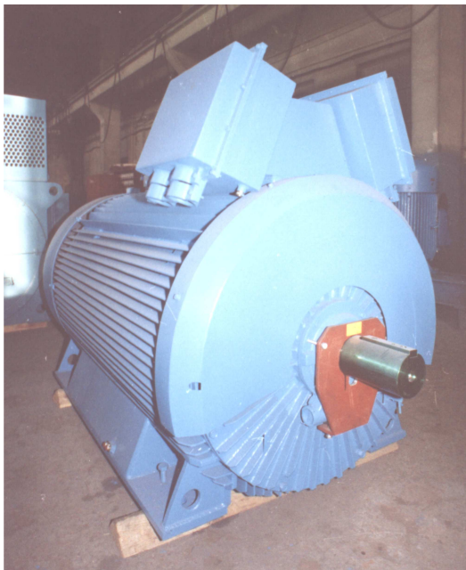
Fot. 4. Silnik indukcyjny 1400 kW, 6-fazowy z niesymetrycznym rozłożeniem osi faz
