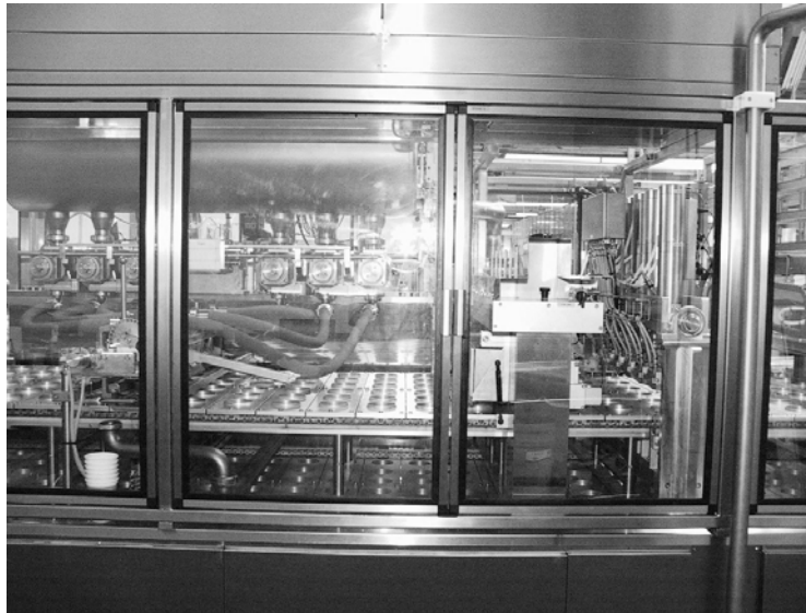
Rys. 3. Widok fragmentu obudowy automatu z widocznymi szczelinami w ekranie
