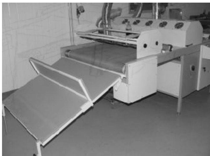
Rys. 4. Widok przykładowego tunelu do utwardzania farb i lakierów
