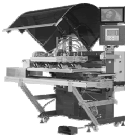
Rys. 6. W pełni zautomatyzowane urządzenie typ ASP 100LS/CD do dwukolorowego nadruku na przedmiotach płaskich metodą sitodruku z zastosowaniem farb UV
