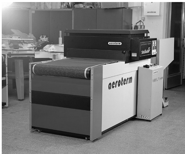
Rys. 14. Modułowy system do suszenia i utwardzania nadruków na tekstyliach IRT Vario
