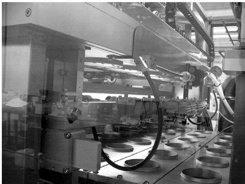
Rys. 2. Widok fragmentu automatu podającego z włączonymi promiennikami UV-C
