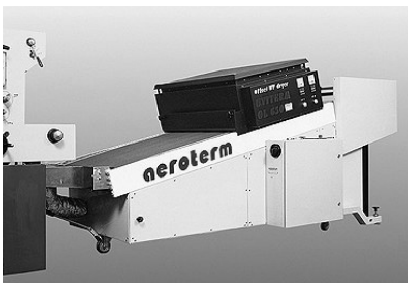
Rys. 5. Przykładowy tunel do utwardzania lakierów UV naniesionych przez maszyny offsetowe Uviterm OL 770 ASNY
