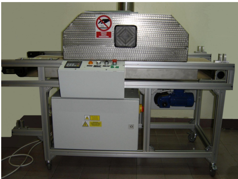
Rys. 1. Laboratoryjny promiennik UV HF4. POLMATEX-CENARO (6)
