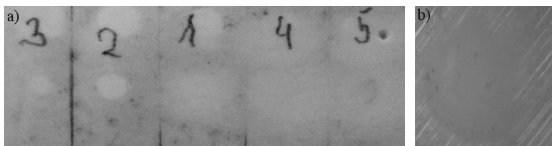
Rys. 13. Efekty oddziaływania trzeciej harmonicznej (355 nm) z próbką kości słoniowej z rys. 2b): a) ślad 1 – pojedynczy impuls, 1,6 \text{ J/cm}^2 , ślad 2 – pojedynczy impuls, 2,3 \text{ J/cm}^2 , ślad 3 – pojedynczy impuls, 4,9 \text{ J/cm}^2 , ślad 4 – 40 impulsów, 10 Hz, 0,6 \text{ J/cm}^2 , ślad 5 – 50 impulsów, 10 Hz, 0,9 \text{ J/cm}^2 , b) pojedynczy impuls, 4,9 \text{ J/cm}^2 (powiększenie 12×)
