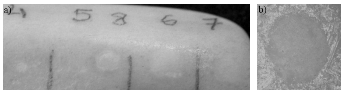
Rys. 14. Efekty oddziaływania trzeciej harmonicznej (355 nm) z próbką kości słoniowej z rys. 2c): a) ślad 4 – pojedynczy impuls, 6,8 \text{ J/cm}^2 , ślad 5 – pojedynczy impuls, 26,8 \text{ J/cm}^2 , ślad 6 – 55 impulsów, 10 Hz, 1,0 \text{ J/cm}^2 , ślad 7 – 55 impulsów, 10 Hz, 1,3 \text{ J/cm}^2 , ślad 8 – 55 impulsów, 10 Hz, 2,2 \text{ J/cm}^2 , b) pojedynczy impuls, 6,8 \text{ J/cm}^2 (powiększenie 12×)
