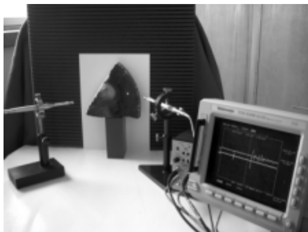
Rys. 3. Widok stanowiska diagnostycznego do pomiaru amplitudy fali akustycznej. Widoczne dwa czujniki ciśnienia usytuowane w różnych odległościach od próbki (100 i 200 mm) pod kątami 45° w jednej płaszczyźnie (widoczna plamka pilotująca lasera He-Ne)
