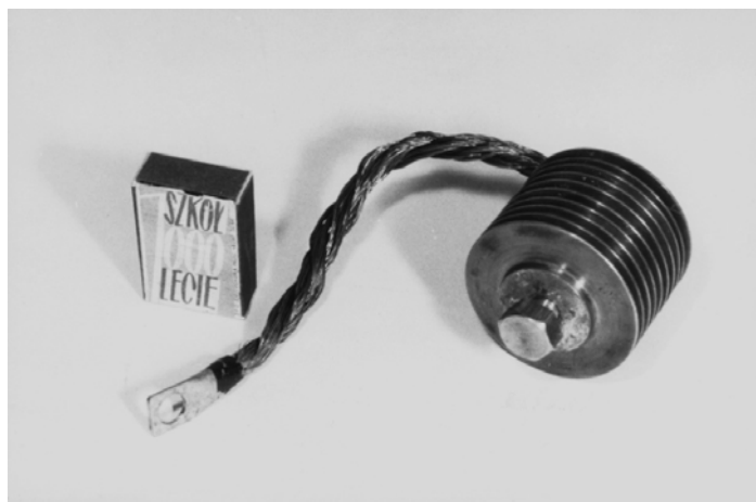
Rys. 4. Dioda germanowa (100 A, 75 V) wykonana w Instytucie Podstawowych Problemów Techniki PAN
