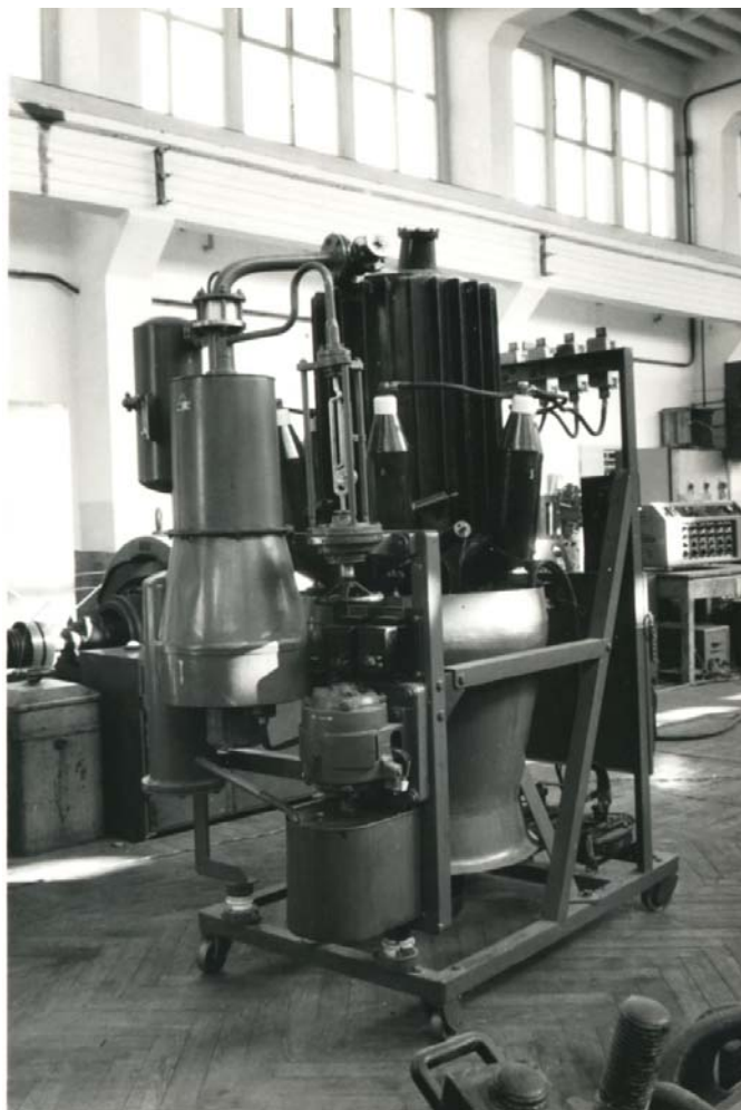
Rys. 1. Prostownik rtęciowy PR-06 (660 V lub 250 V, 600 A). Opracowanie Fabryka Prostowników KATODA w Łodzi przy współpracy Instytutu Elektrotechniki w zakresie badań i oceny. Produkowany w latach 1959...1967 w kilku odmianach konstrukcyjnych. W okresie tym dostarczono do podstacji miejskich i kopalnianych kilkaset prostowników tego typu, dzięki czemu zahamowano praktycznie import
