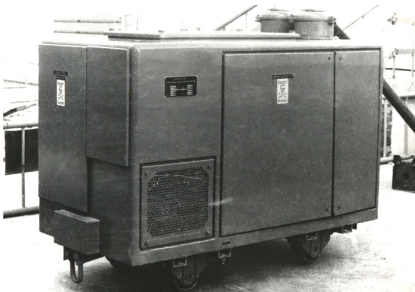
Rys. 5. Automatyczna przewoźna stacja prostownikowa typu APSPA-100/6-250 (100 kW, 250 V). Opracowanie i wykonanie układu prostowniczego Instytut Elektrotechniki, opracowanie automatyki i wykonanie kompletnej stacji: Zakłady Konstrukcyjno-Mechanizacyjne Przemysłu Węglowego w Katowicach. Produkcja: Mikołowska Fabryka transformatorów
