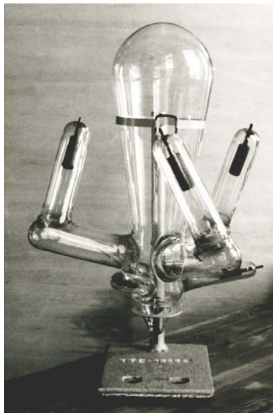
Rys. 2. Szklany trójfazowy prostownik rtęciowy (60 A, 400 V) zaprojektowany i wykonany w Instytucie Elektrotechniki (1954 r.)
