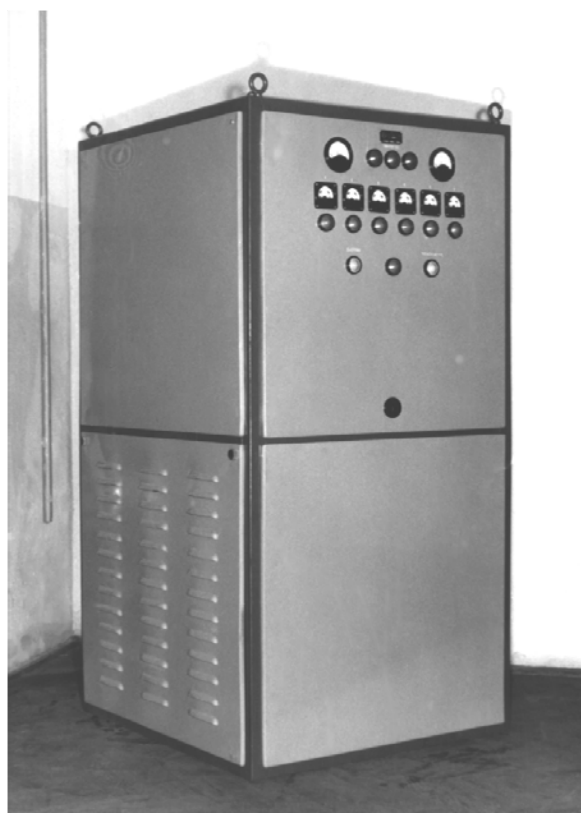
Rys. 3. Pierwszy eksperymentalny prostownik germanowy PG-03 (250 V, 300 A) dla trakcji elektrycznej kopalnianej. Opracowanie i wykonanie Instytut Elektrotechniki (1959-1960)
