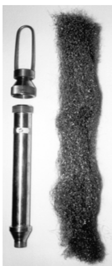
Rys. 4. Matryca separatora wysokogradientowego (a) i jej wypełnienie watą ferromagnetyczną (b); powiększenie włókna waty (c); przekrój włókna (d)
