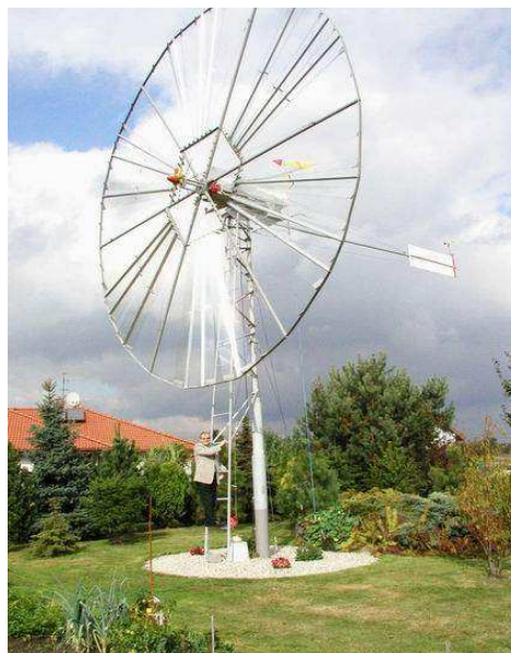
Rys. 1. Widok drobnej elektrowni wiatrowej o mocy prądnicą 10 kW, 250 obr/min, przekładnia jednostopniowa (opracowana przez współautora TG)
