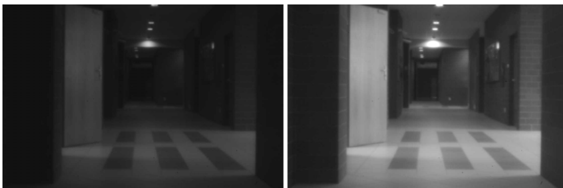
Rys. 2. Obrazy tych samych obszarów zarejestrowane przy różnych poziomach czułości detektora
