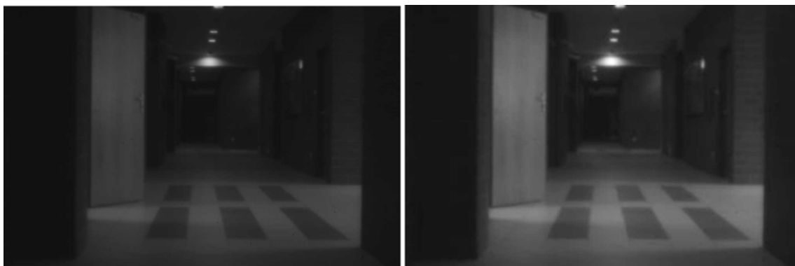
Rys. 3. Obrazy tych samych obszarów zarejestrowane przy różnych czasach ekspozycji detektora
