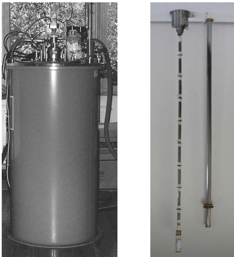
Rys. 1. Widok elektromagnesu nadprzewodnikowego (lewa strona) oraz wstawki do pomiaru magnetyzacji z kontr-kriostatem (prawa strona)
