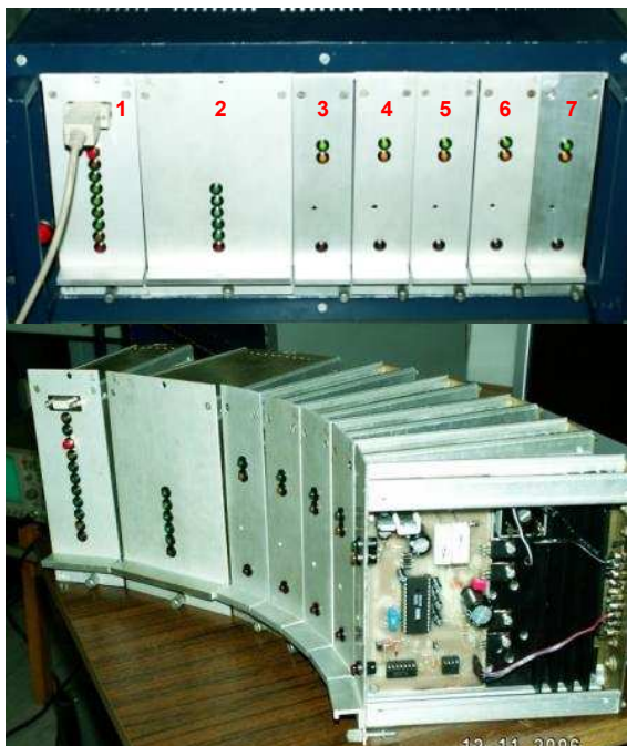
Rys.3. Modułowa konstrukcja układu sterowania robota IRb-6
