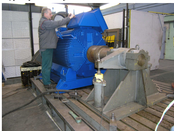
Rys. 2. Stanowisko do pomiarów silników elektrycznych dużej mocy na płycie pomiarowej w trakcie pomiaru momentu rozruchowego silnika
