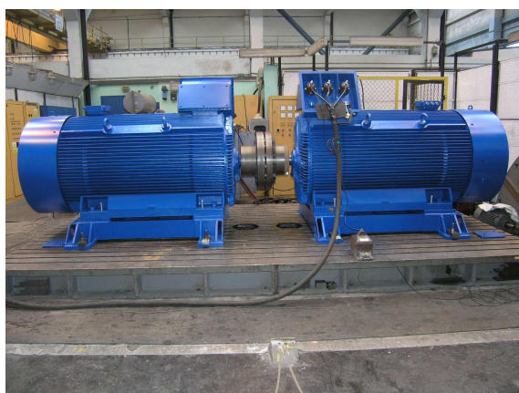
Rys. 3. Próba obciążenia silników 1MW, 6kV metodą pracy zwrotnej, na stanowisku pomiarowym
