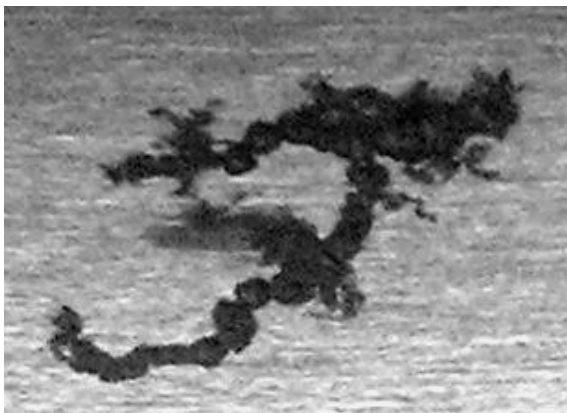
Rys. 4. Widoczne zygakowate przypalenia na powierzchni wewnętrznej pierścienia zewnętrznego
