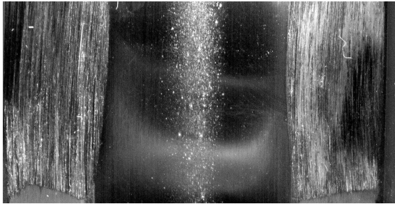
Rys. 19. Widoczne liczne małe wżery na powierzchni wewnętrznej pierścienia zewnętrznego łożyska kulkowego
