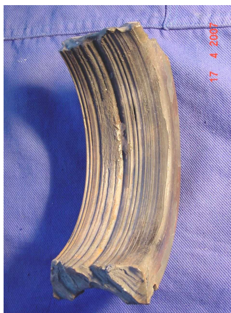
Rys. 1. Fragment łożyska 6328 silnika 1400 kW, 1500 obr/min zniszczonego osiowym dociskiem wału od jego wydłużeń cieplnych. Łożysko zostało zablokowane, pierścień bieżni wewnętrznej zaczął obracać się (ślizgać) na wale. W oryginalnym rozwiązaniu konstrukcyjnym przewidziano zbyt mały luz osiowy w łożyskowaniu jak dla silnika napędzającego wentylator o długim czasie rozruchu
