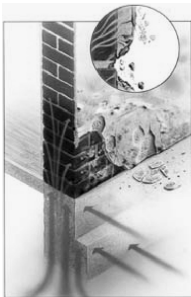
Rys. 1. Zawilgocenie ścian budynków [1]: a) wizualizacja procesu zawilgocenia ściany, b) uszkodzenia ściany spowodowane zawilgoceniem
