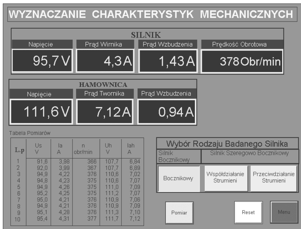
Rys.2. Widok pulpitu operatorskiego aplikacji pomiarowej do wyznaczenia charakterystyki mechanicznej silnika
