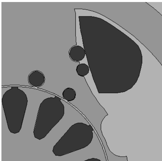
Rys.6. Przekrój poprzeczny silnika SFZ, dwa zwoje zwarte okrągłe
