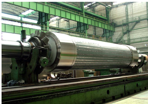
Rys.7. Widok wirnika generatora TGH-120 po modernizacji
