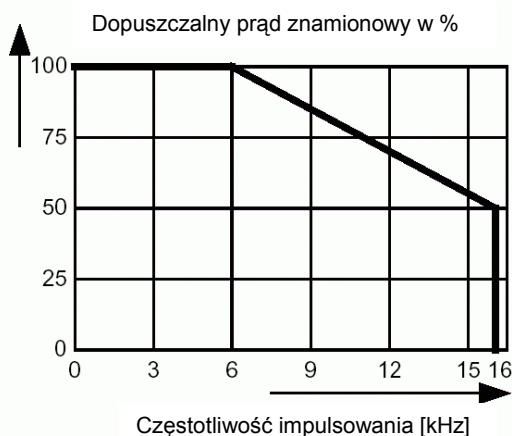
Rys.1. Przykładowa charakterystyka przedstawiająca możliwości modulatora PWM. [1]
