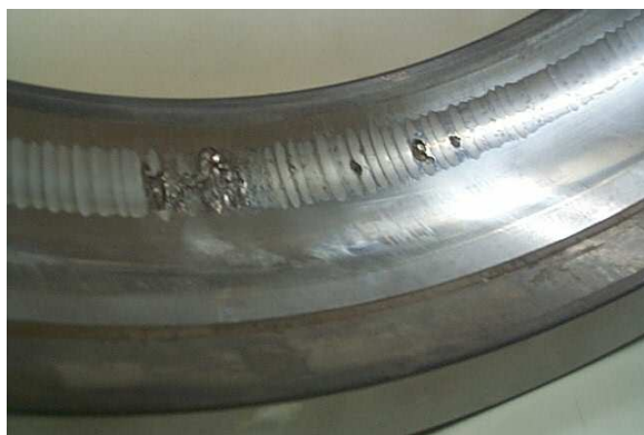
Rys.4. Uszkodzenie bieżni łożyska wywołane przepływem prądu łożyskowego
