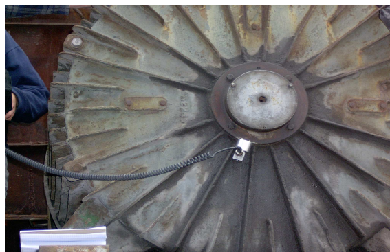
Rys.1. Usytuowanie akcelerometru na silniku przy diagnostyce łożysk tocznych
