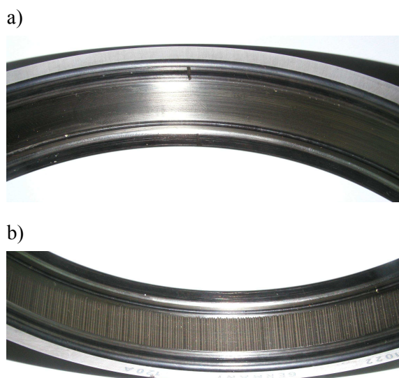
Rys.5. Prążki na bieżni pierścienia zewnętrznego łożyska walcowego: a) – brak prążków w górnej części pierścienia, b) – prążki w dolnej części pierścienia
