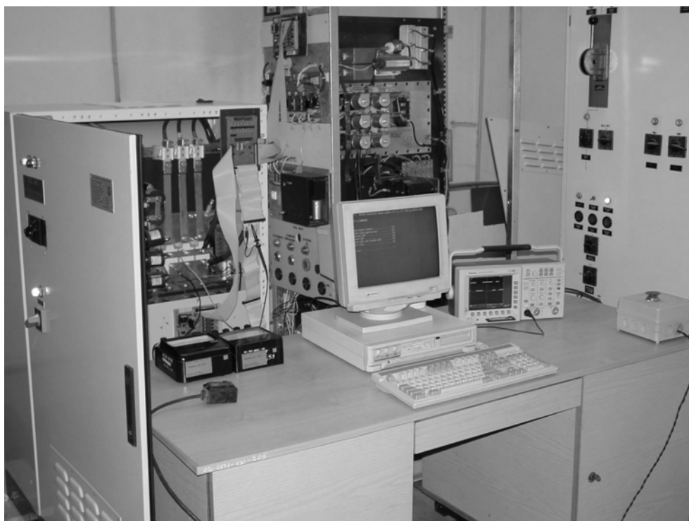
Rys. 6.6. Model laboratoryjny przekształtnika OVT. Falownik widoczny z lewej strony pełni rolę falownika pomocniczego
