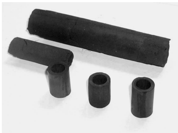
Rys. 9. Widok wypalonych ekranów z ceramiki bizmutowych typu Bi:2212. Najdłuższy ekran ma 5 cm
