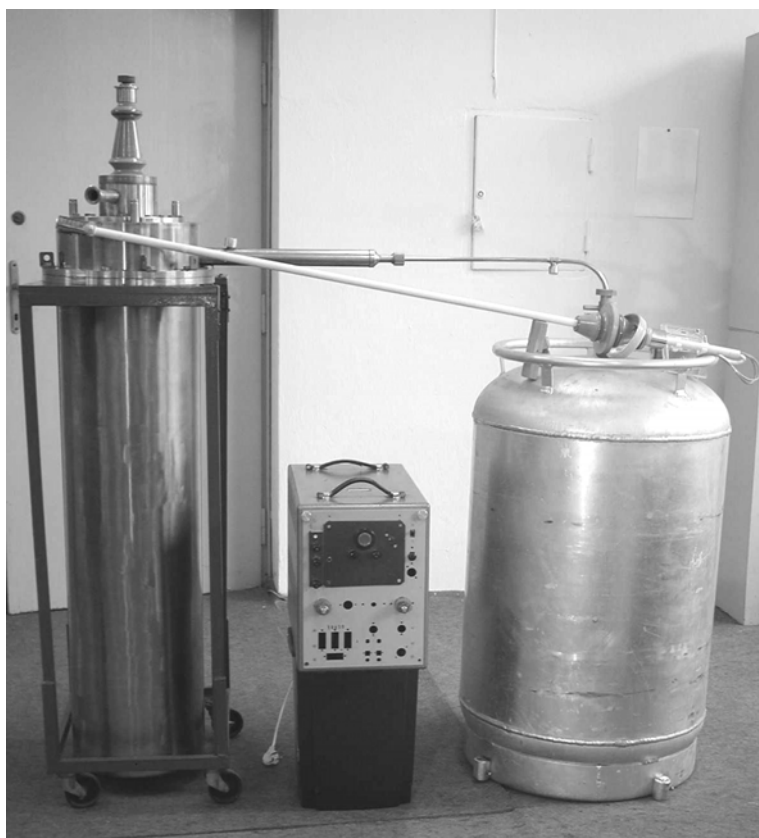
Rys. 2. Fotografia rezystywnego nadprzewodnikowego ogranicznika prądowego: od lewej - kriostat z przepustem wysokonapięciowym, elektroniczny układ sterujący i rozłączający, zbiornik transportowy. Położony jest uchwyt z nadprzewodnikowym elementem czujnikowym
