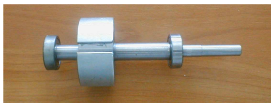
Zdjęcie nr 1. Widok wirnika z naklejonymi magnesami
