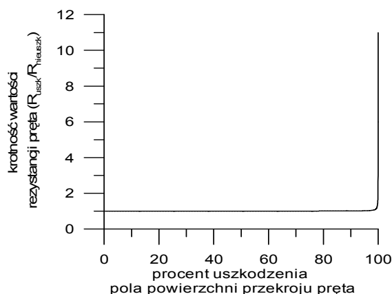
Rys. 3. Wykres zależności rezystancji pręta od stopnia jego uszkodzenia dla modelu rezystancyjnego dokładnego.
