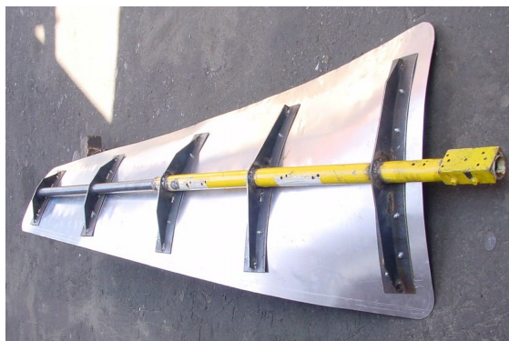
Rys.5. Uzębrowane śmigło wiatraka po nałożeniu blachy
