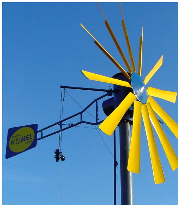
Rys.3. Wiatrak 3 kW wybudowany na dachu Ośrodka Komel (w Sosnowcu) z wykorzystaniem prądnicy synchronicznej z magnesami trwałymi PMGg160L-16
