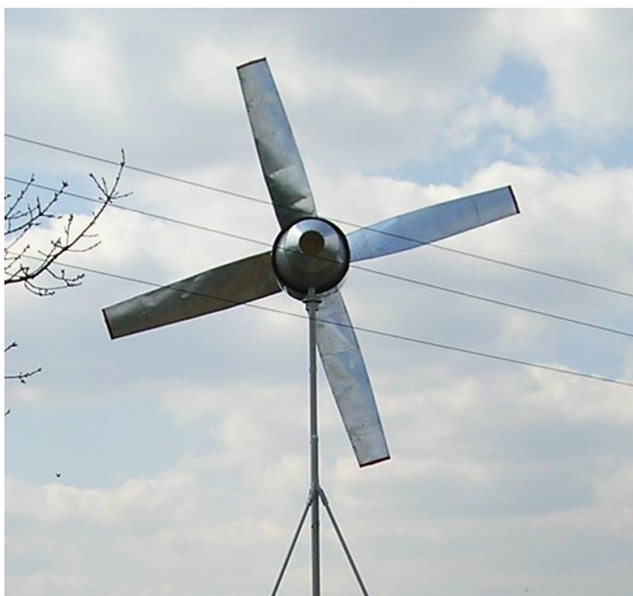
Rys.8. Elektrownia wiatrowa z prądnicą tarczową
