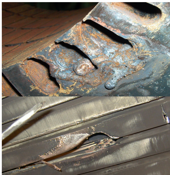
Rys.7. Defekt rdzenia stojana wywołany zwarciem zwojowym
