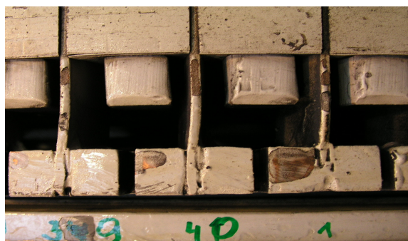
Fot.3 Krzywe pręty klatki
