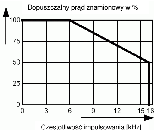
Rys. 1. Przykładowa charakterystyka przedstawiająca przykładowe możliwości modulatora PWM.
