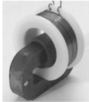
Rys. 2.37. Nadprzewodnikowy ogranicznik prądu 31 z cylindrem CST-15/15 chłodzony w całości technika w kąpieli ciekłego azotu
