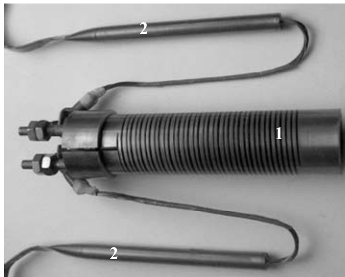
Rys. 2.34. Rezystancyjny SFCL bez kriostatu 28 : 1 – stos Bi-2212 - C02-034 bifilar coil, 2 – przepusty prądowe Bi-2223 – CSL-120-L.2 w obudowie
