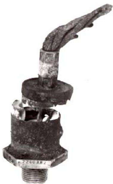
Rys.5.1. Dioda po eksplozji w wyniku zwarcia w prostowniku trakcyjnym starszej generacji.
