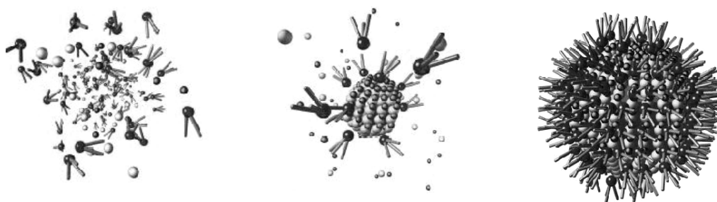
Rys.8. Kolejne etapy tworzenia kropki kwantowej [5].
