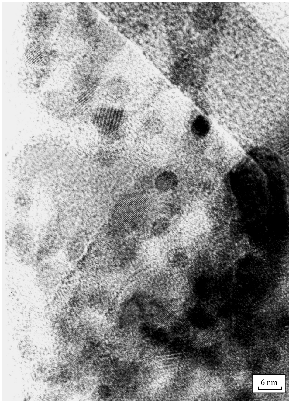
Rys.6.5. Mikrostruktura (\text{FeCuNb})_{77,5} (\text{SiB})_{22,5} po obróbce cieplnej w temperaturze 793 K w ciągu 1 h.
