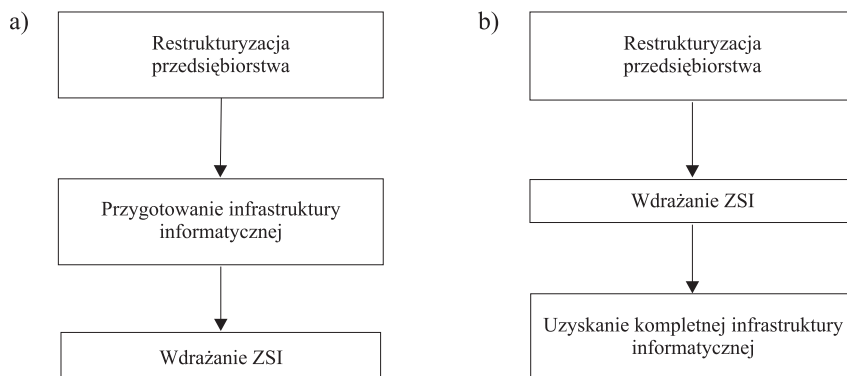
Rys. 5. Realizacja ZSI: a) konwencjonalna; b) zalecana
