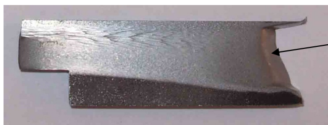
Rys. 1. Zdjęcie zużytej erozyjnie łopatki młyna wirnikowego
