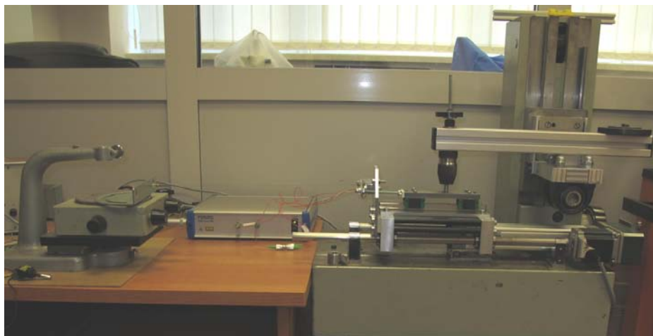
Rys. 1. Stanowisko do badania współczynnika tarcia statycznego
