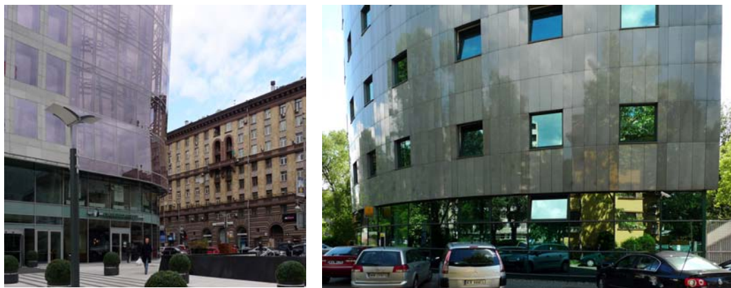
Ryc. 8. Przykłady współczesnych cokółów obejmujących przeszklenie parteru: Moskwa (po lewej) i Kraków (po prawej). Źródło: fot. J. Kurek
