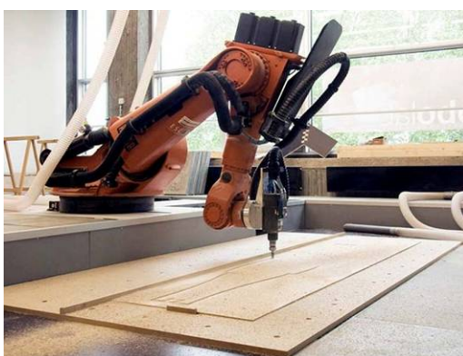
Ryc. 4. Zdjęcie pokazujące proces wycinania sklejkę ramieniem robota przemysłowego. Źródło: http://icd.uni-stuttgart.de .
