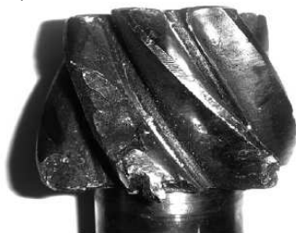
Rys. 2. Fotografie najgroźniejszych form zużycia kół zębatych stożkowych: a) zacieranie i powierzchniowe zużycie zmęczeniowe (pitting) [L. 13], b) wyłamanie zęba [L. 14]
