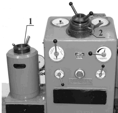
Rys. 1. Widok hydraulicznego urządzenia do tłoczenia blachy firmy Erichsen: 1 – urządzenie wykrawające, 2 – głowica badawcza
