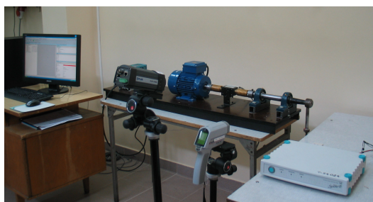
Rys. 1. Stanowisko do badań łożysk ślizgowych z wykorzystaniem metod energetycznych
