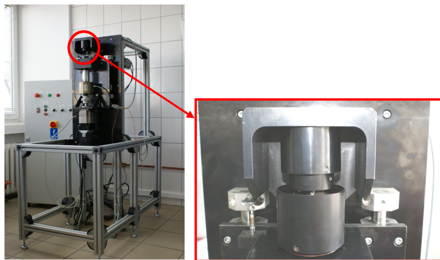
Rys. 2. Widok symulatora do badań tribologicznych implantów kręgosłupa wraz z skaldem pary trącej
