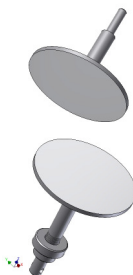
Rys. 1. Tarcze testowe do badania siły rozrywania powierzchni pokrytych smarem
