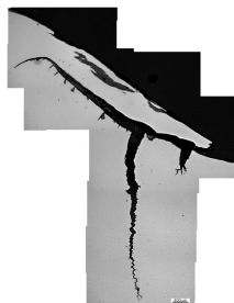
Rys. 5. Zgląd nietrawiony (równoległy do promienia i osi stempla) w obszarze przypowierzchniowym stempla
