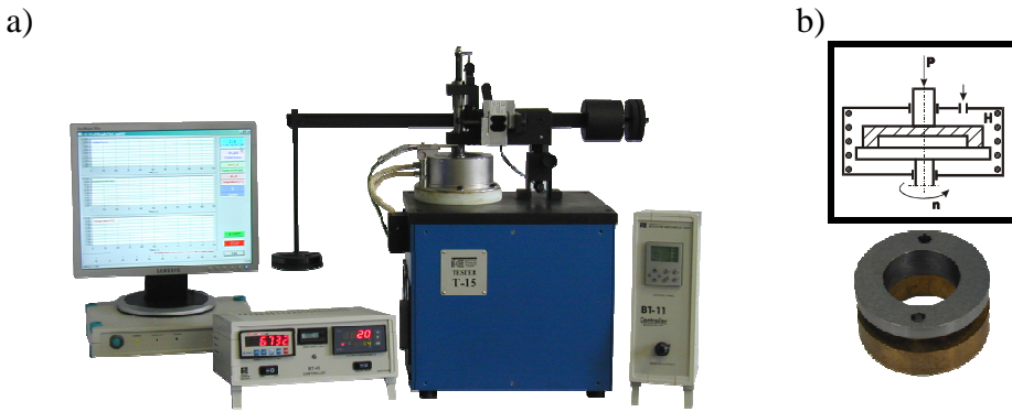
Rys. 5. Stanowisko T-15 ze stykiem rozłożonym: a) widok ogólny, b) schemat węzła tarcia
