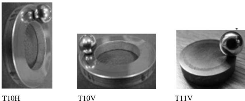
Rys. 1. Ustawienie węzła tarcia w testerach T10 i T11
