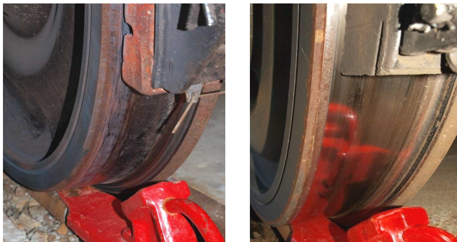
Rys. 6. Powierzchnia tarcia koła po hamowaniu: wstawką żeliwną i z kompozytu [L. 7]
